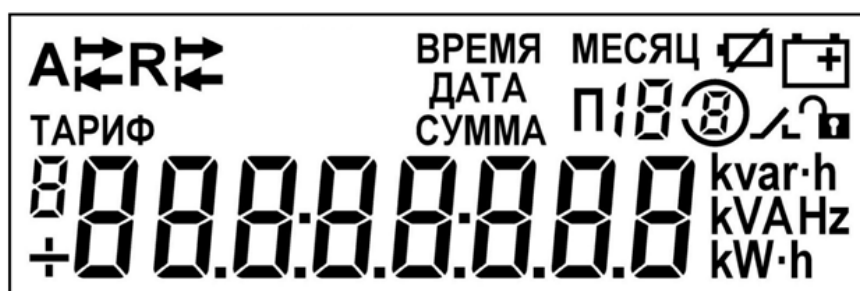
Рисунок 10 - Общий вид ЖКИ блока индикации счетчика в корпусе SPLIT
