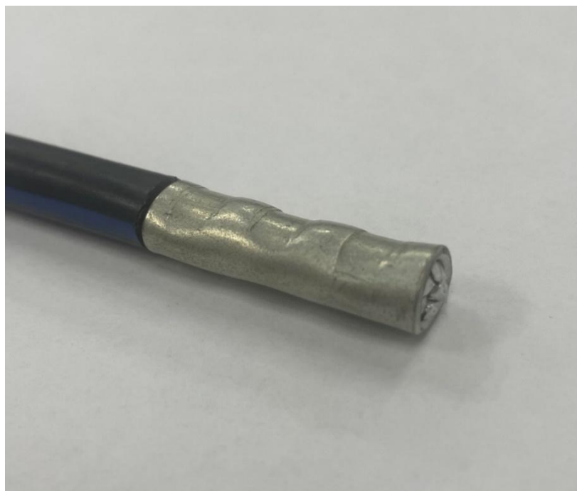
Рисунок 26 - Пример обжатия многожильного провода
